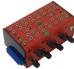
Abbildung 2: Messinterface für Commodore64
